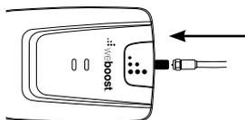
3. Attachez l'antenne intérieure vers le connecteur étiqueté «Antenne intérieure» (Inside Antenna).
