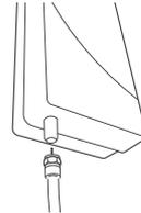
6. Acheminez le câble vers l'emplacement de l'amplificateur Home 3G. Si vous devez connecter les deux câbles coaxiaux, utilisez le connecteur fourni.
