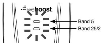
**Vert** indique que l'amplificateur de signal est allumé et fonctionne avec un gain maximum.
