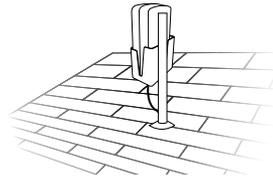
3. À l'aide du matériel fourni dans l'emballage A, insérez le boulon U dans les trous de l'antenne extérieure. Faites glisser la moitié du support dans le boulon U.
